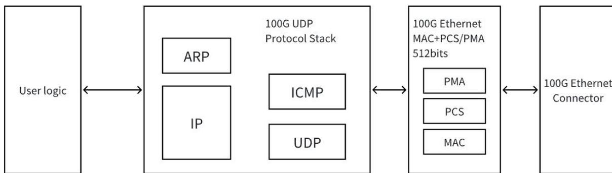
UDP 协议栈 IP Core 与用户接口、Ethernet MAC+PCS/PMA IP 接口均为标准的 AXI4-Stream 接口，其中 Ethernet MAC+PCS/PMA 可以是任何第三方的 IP，在提供的设计实例中，使用的是 Xilinx 的 100G Ethernet Subsystem IP。
